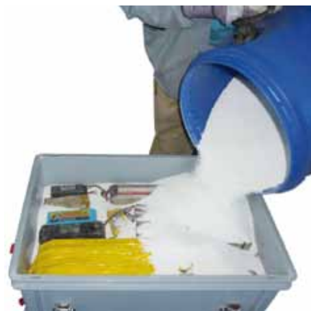
Les piles usagées sont entreposées dans un caisson sécurisé et recouvertes de PyroBubbles®
