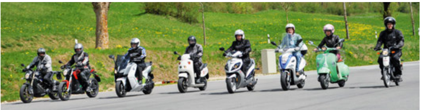
Abb. 15: Die Testflotte von links nach rechts: Brammo Empulse R (max. Geschwindigkeit: 177 km/h), Zero SR (164 km/h), BMW C Evolution (120 km/h), vRone (100 km/h), Emco Novum S 5000 (82 km/h), Etrix S4 (45 km/h), Emco Nova R 2000 (45 km/h), Yamaha EC-03 (45 km/h) (Foto: B. Schneider)
