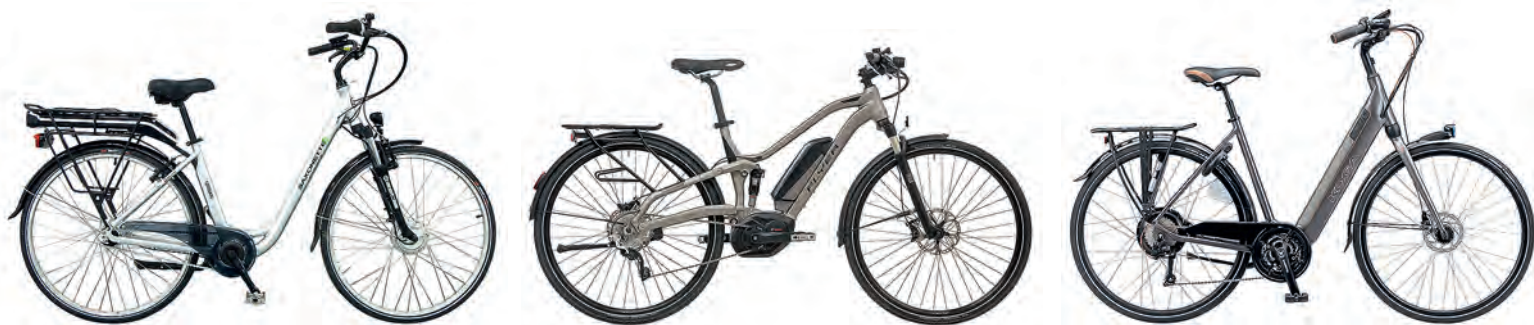
Elektromotor: Entweder im Vorderrad (links), in der Mitte oder im Hinterrad (ganz rechts) angebracht
