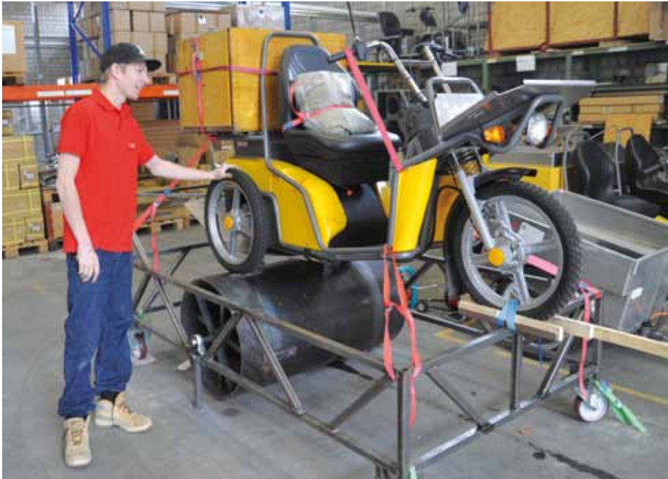
Kyburz-Mitarbeiter Flurin Vicentini präsentiert den Prüfstand: «Für die Kunden ist es genauso von Vorteil wie für uns, wenn wir Schwachstellen bereits auf dem Prüfstand entdecken – damit sie im realen Gebrauch gar nicht auftreten.»
