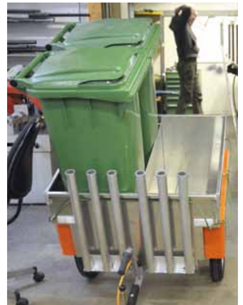
Der Anhänger des DXP kann nach Bedarf konfiguriert werden – hier mit Abfallbehältern und Steckrohren für die Dienstabteilung einer Gemeinde.
