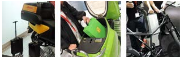
Während ZNEN, WYS und EI-Moto (v.l.n.r.) auf herausnehmbare Batterien setzen, wählt Zero ein 11.4 kWh Batteriepaket, das im US-Fahrzyklus 180 km weit reicht.
