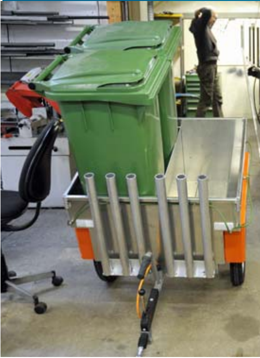
Der Anhänger des DXP kann nach Bedarf konfiguriert werden – hier mit Abfallbehältern und Steckrohren für die Dienstabteilung einer Gemeinde.
