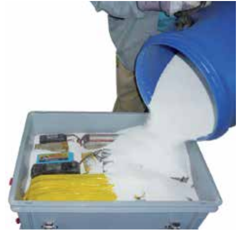
Alte Akkus werden in einer UN-geprüften Transportkiste mit PyroBubbles® bedeckt.
